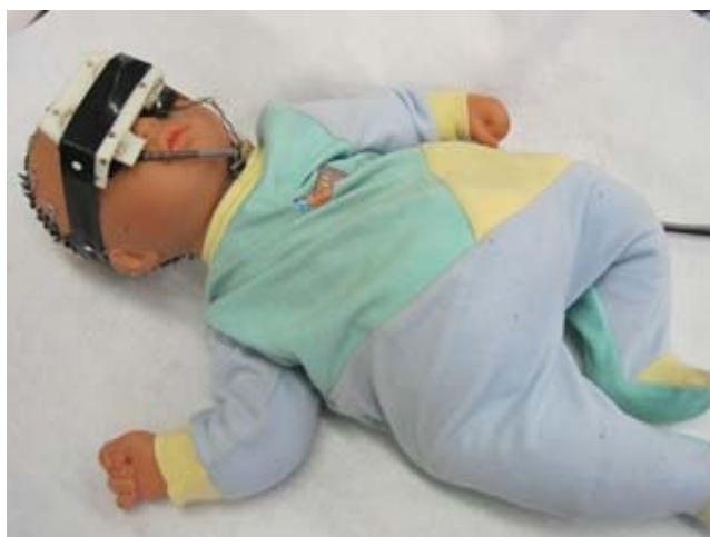
図4：乳幼児揺さぶられ症候群の再現実験に用いた人形と眼球模型
