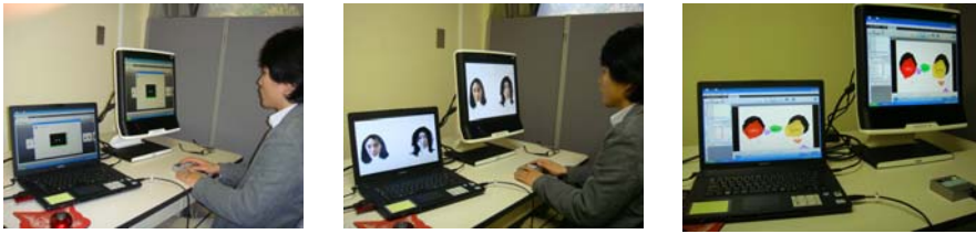
図1 アイトラッカーを用いた実験状況（左2つ）と解析画面例（右端）
